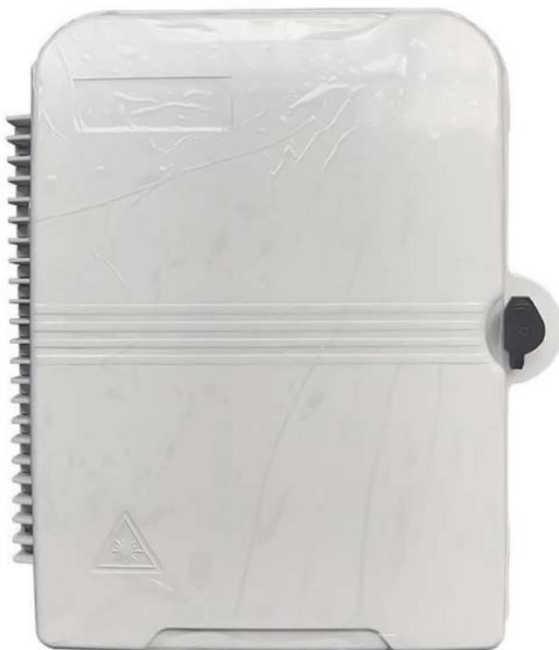
Box di distribuzione per l'accesso in fibra è in grado di contenere fino a 24 abbonati. Viene utilizzato come punto terminale per il cavo di alimentazione per la connessione con il cavo di derivazione nel sistema di rete FTTx. Integra la giunzione, la suddivisione, la distribuzione, lo stoccaggio e la connessione dei cavi della fibra in un'unica solida scatola di protezione.
